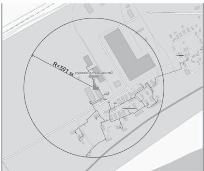
Рисунок 54 - Радиус эффективного теплоснабжения котельной № 2
