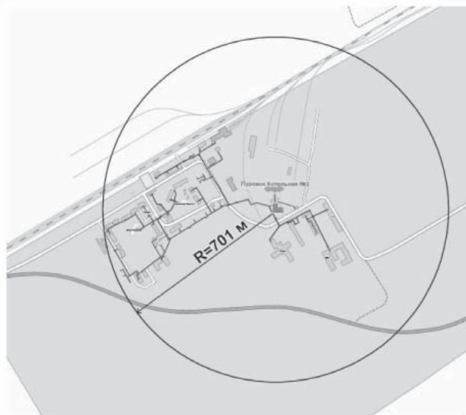
Рисунок 55 - Радиус эффективного теплоснабжения котельной
