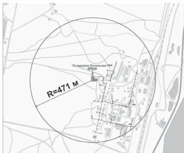
Рисунок 84 - Радиус эффективного теплоснабжения котельной № 4 с. Сывдарма
