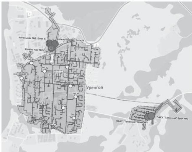
**Рисунок 108 – Зоны теплоснабжения котельных пгт. Уренгой**
