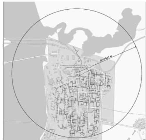
**Рисунок 109 - Радиус эффективного теплоснабжения котельных №№ 2-3**
