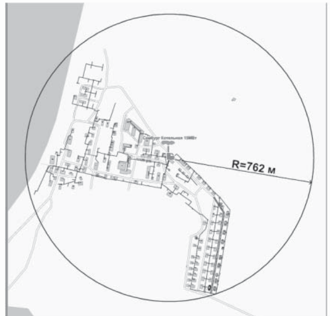
Рисунок 216 - Радиус эффективного теплоснабжения котельной 15,0 МВт с. Самбург
