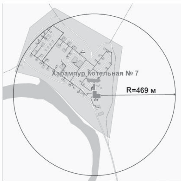
Рисунок 164 - Радиус эффективного теплоснабжения котельной № 7 д. Харампур
