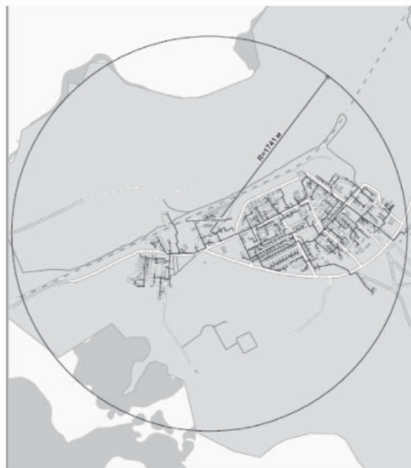
Рисунок 190 - Радиус эффективного теплоснабжения котельной п. Ханымей
