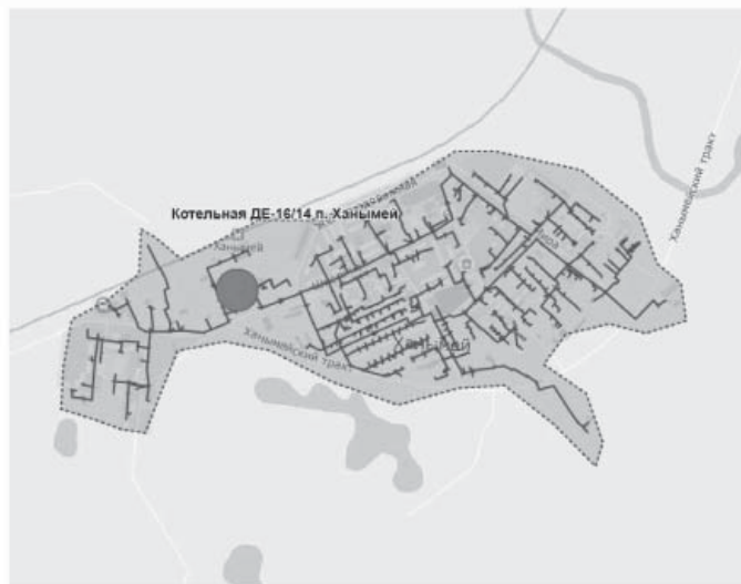
Рисунок 189 – Зоны теплоснабжения котельной п. Ханымей
